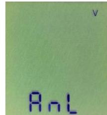
Nach der Auswahl der gewünschten Quelle wird diese durch Betätigung der „ENTER“-Taste übernommen.
