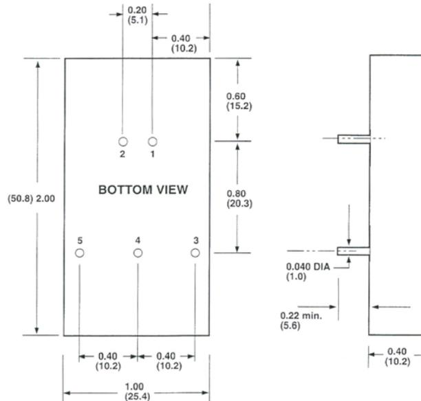
**Pin Belegung / Pin assignment**
