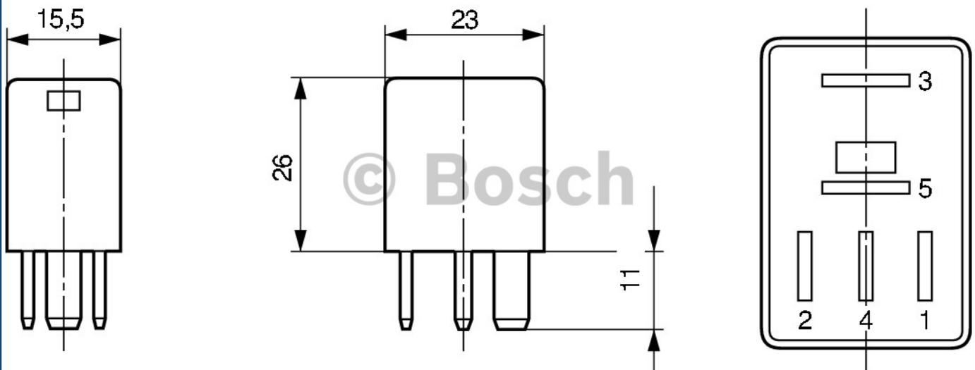
Flachsteckergröße nach DIN 46 244 ähnlich ISO 8092: Kl. 1 u. 2 (4): 4,8 x 0,8 mm; Kl. 3 und 5: 6,3 x 0,8 mm
