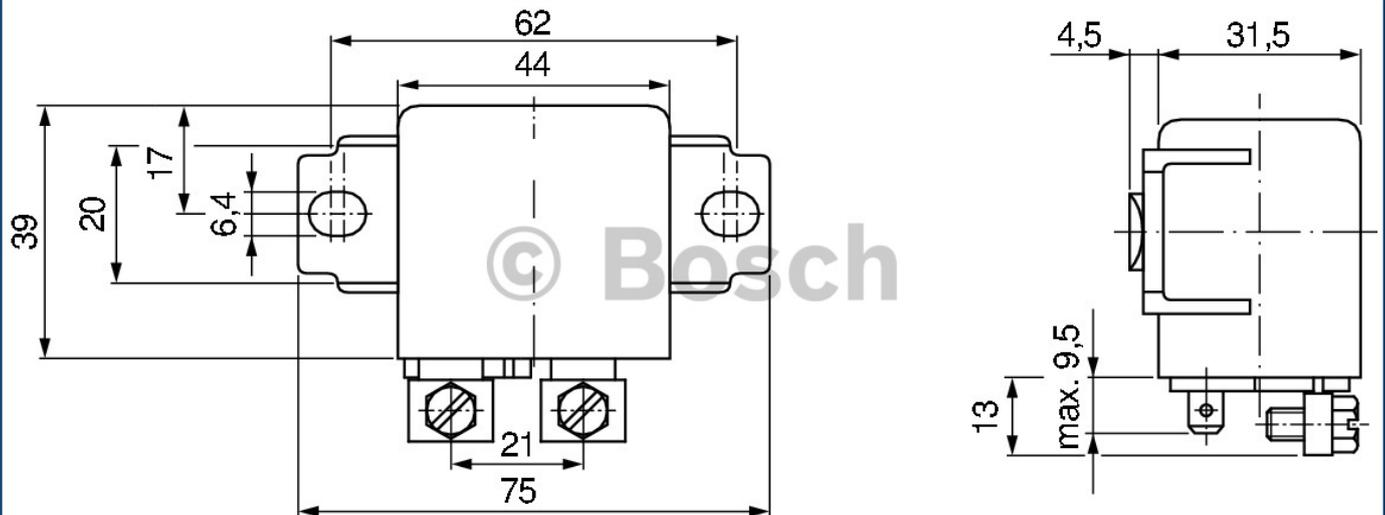
Zubehör: Zweifaches Steckhülsegehäuse für Erregerseite (Kl. 85 und 86). Zu bestellen mit der Tyco (AMP)-Nummer 180 907 bei: Tyco (AMP) Deutschland GmbH, Amperestraße 7-11, D-63225 Langen, Tel. 0 61 03/70 90.
