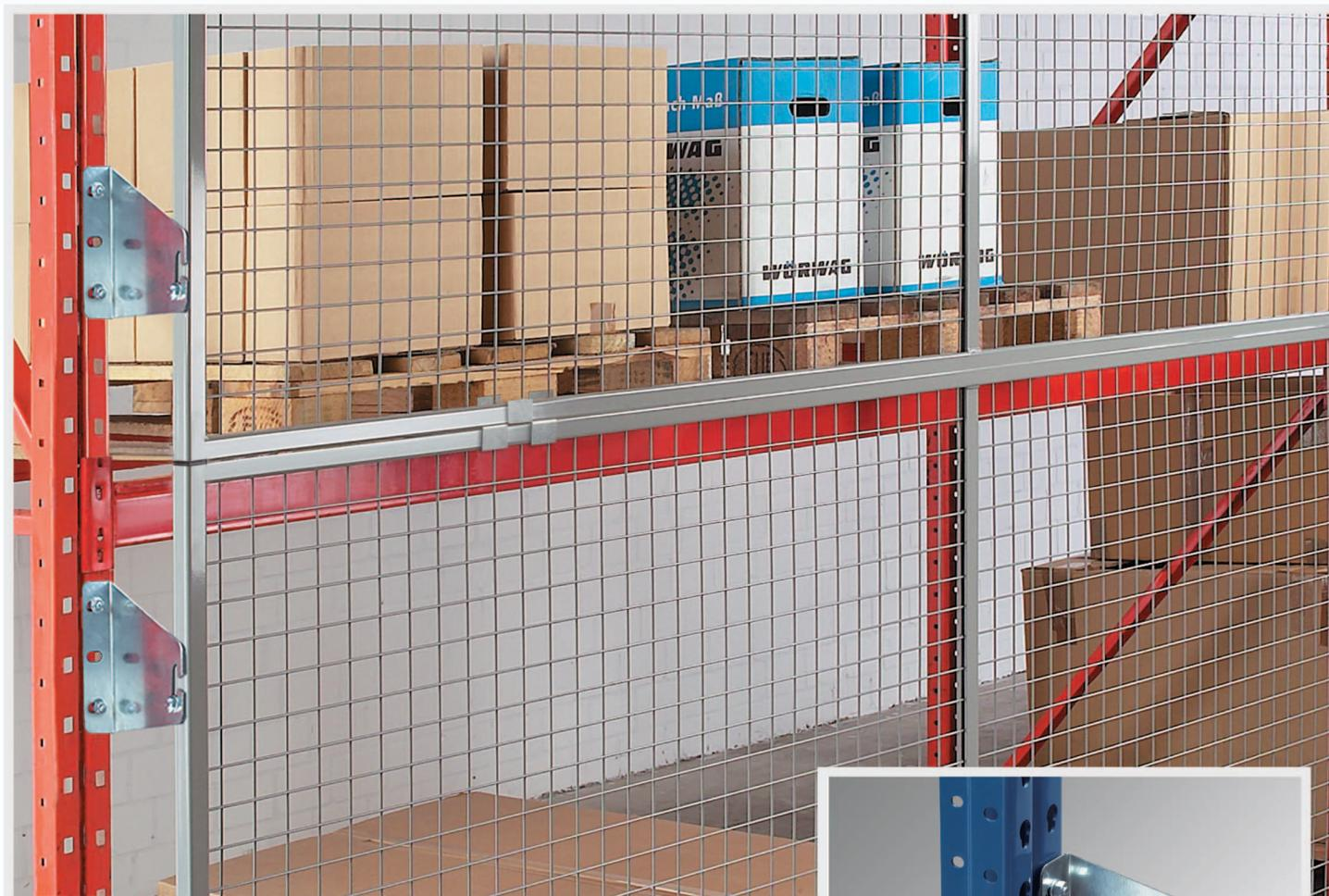
Als Sturz- und Durchschiebesicherung von Palettenregalrückwänden. Sichert Verkehrswege und Arbeitsbereiche hinter den Regalen. Der Überstand beträgt 120 / 150 mm (Art. 9297) oder alternativ 170 / 200 mm (Art. 9298).
