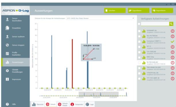
PC-Software ASPION G-Log Manager für Windows ab Version 7 zur Aktivierung, Steuerung sowie Analyse von Auswertungen
