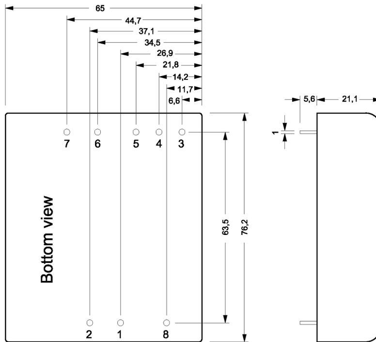
**Pin Belegung/ pin assignment**
